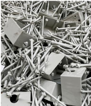
*Fehlerhafte Produktion und Angüsse*
